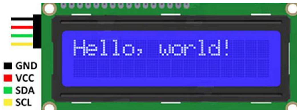
Рис. 1. Подключение модуля ЖКИ к Ардуино
